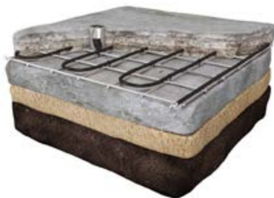
Montare în beton
