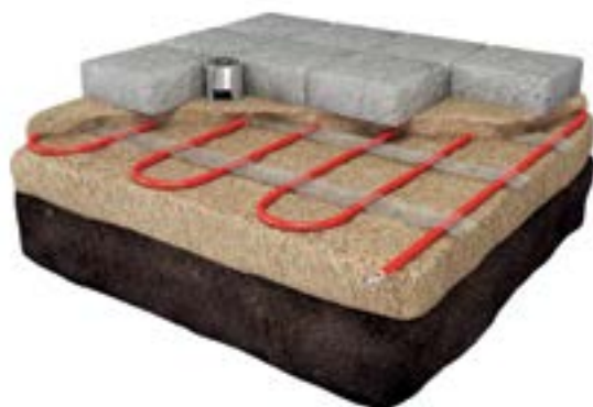
Montare sub pavaj
